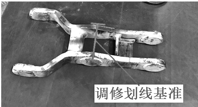
图 1 制动杠杆调修基准
