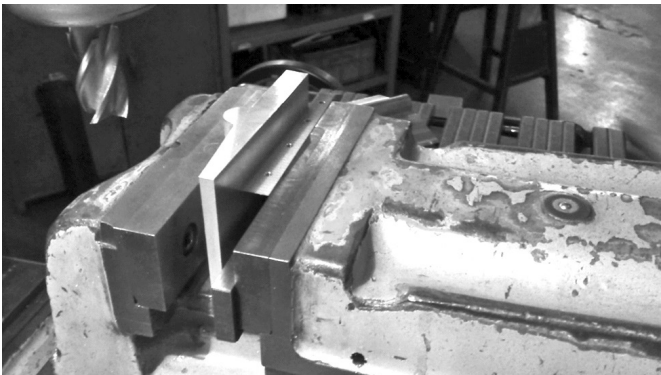
图 9 简易斜面工装在喇叭脊加工中的装夹示例
