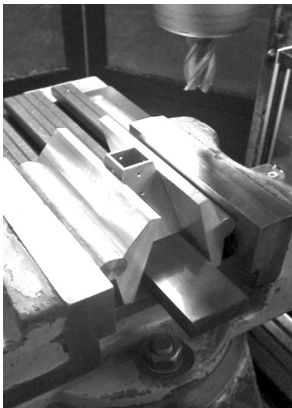
图 5 角锥喇叭铣法兰盘装夹实际示例图
