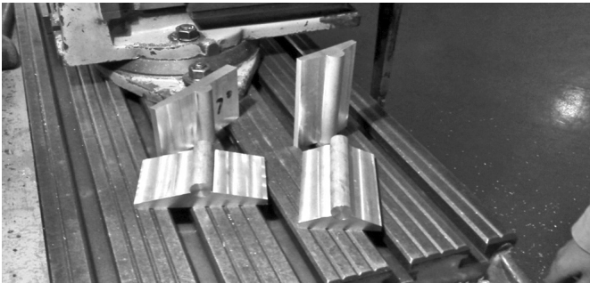
图 8 两组四件简易斜面工装示例
