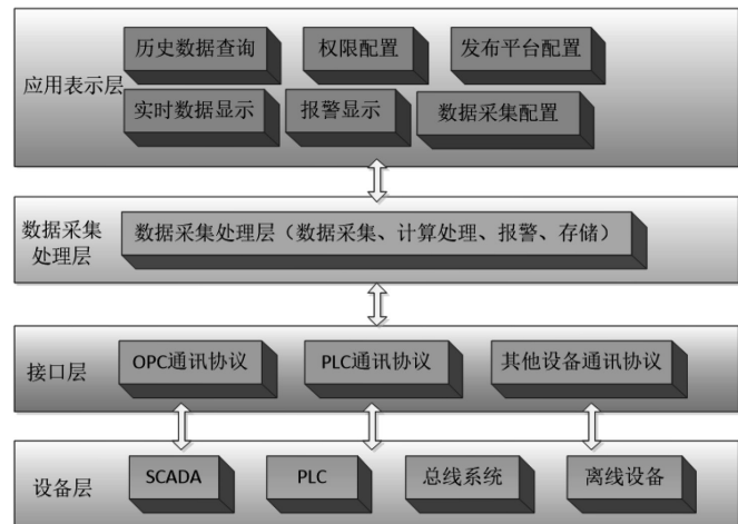
图3 中信戴卡生产过程数据采集与分析系统构架
