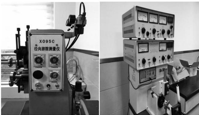
图1 轴承产品游隙、振动测量设备
