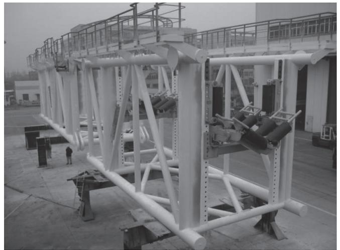
图 5 制造完成的臂架组件
