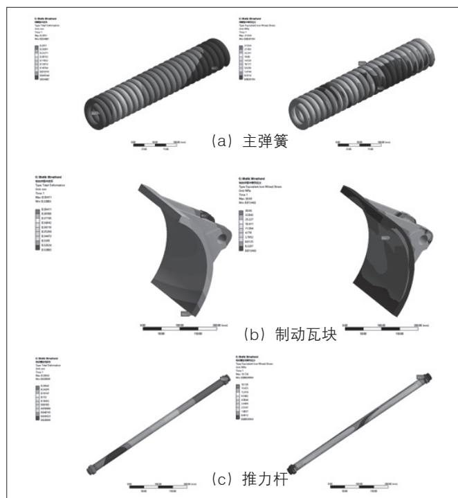
图 5 零部件位移和应力分布
