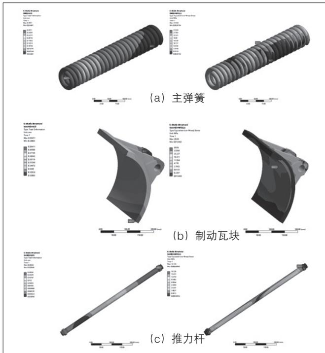
图5 零部件位移和应力分布
