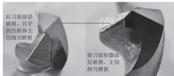
图 1 前刀面与后刀面的磨损状态
