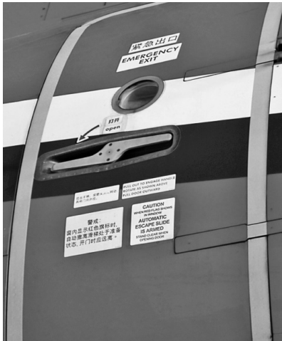
图 1 安装的现有适航标牌
