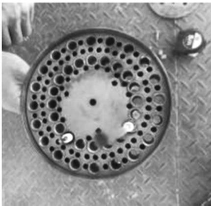
图4 改变结构设计的燃烧器
