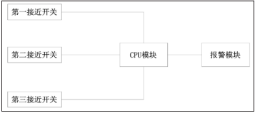
图 3 接近开关和处理与报警装置的信号连接示意图
