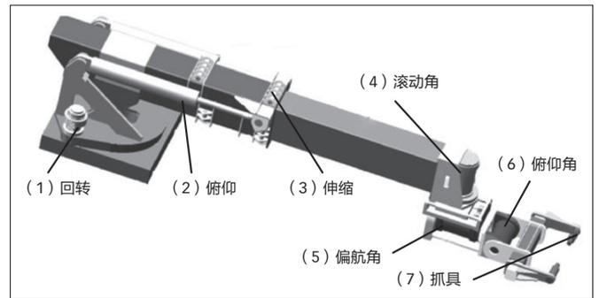
图1 液压重载机械手结构示意图
