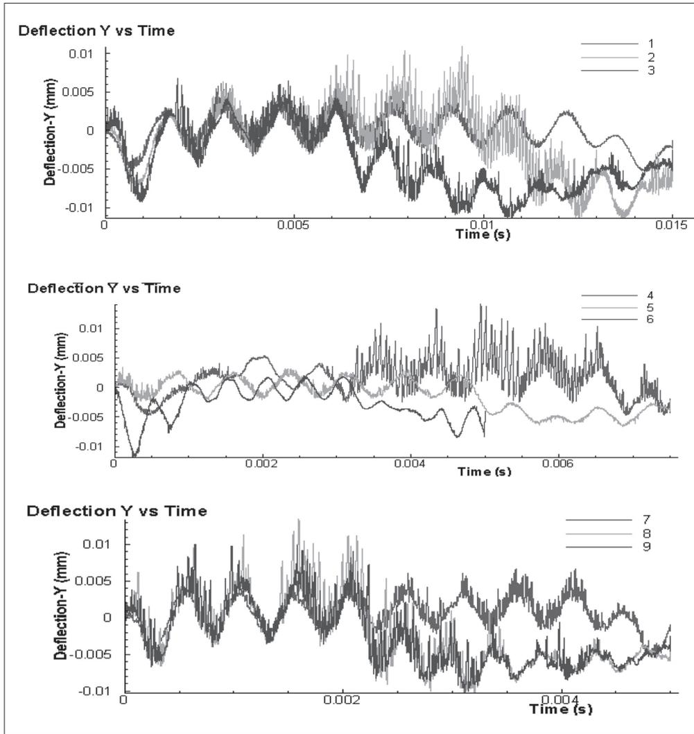
图7 刀具弹性弹性变形量与切削参数仿真结果
