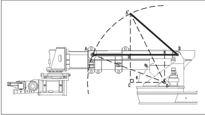
图2 液压缸伸长长度与俯仰角  $q_2$  的几何关系
