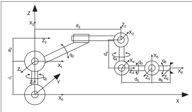
图3 机械手坐标系模型
