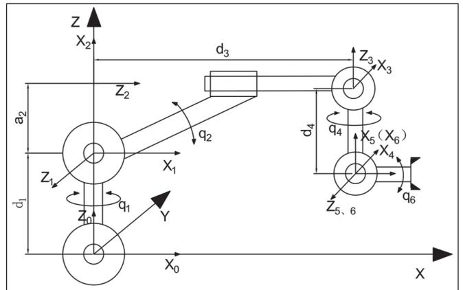
图4 所构造机械手坐标系模型
