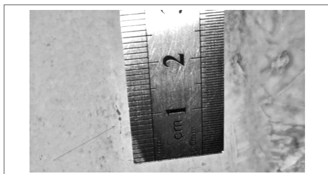
图3 油缸渗透探伤缺陷显示
