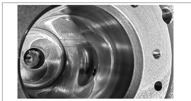
图4 油缸内裂纹长度
