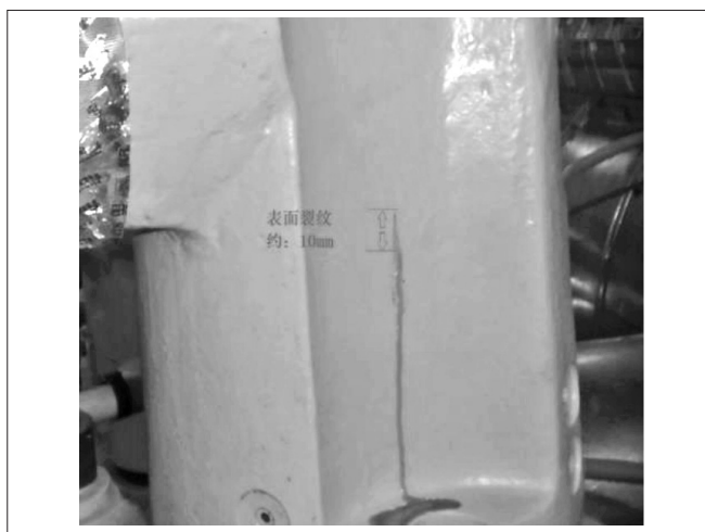
图2 油缸外观裂纹长度
