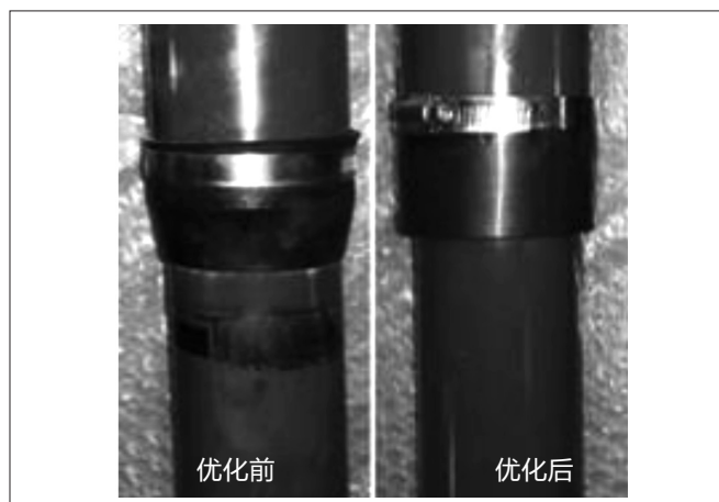
图 8 防尘套防磨损优化前后对比图
