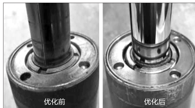
图 10 骨架油封磨损优化前后对比图
