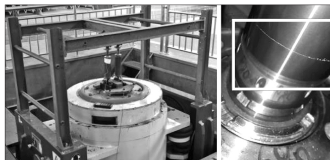
图 4 冲击振动试验（未出现渗油现象）
