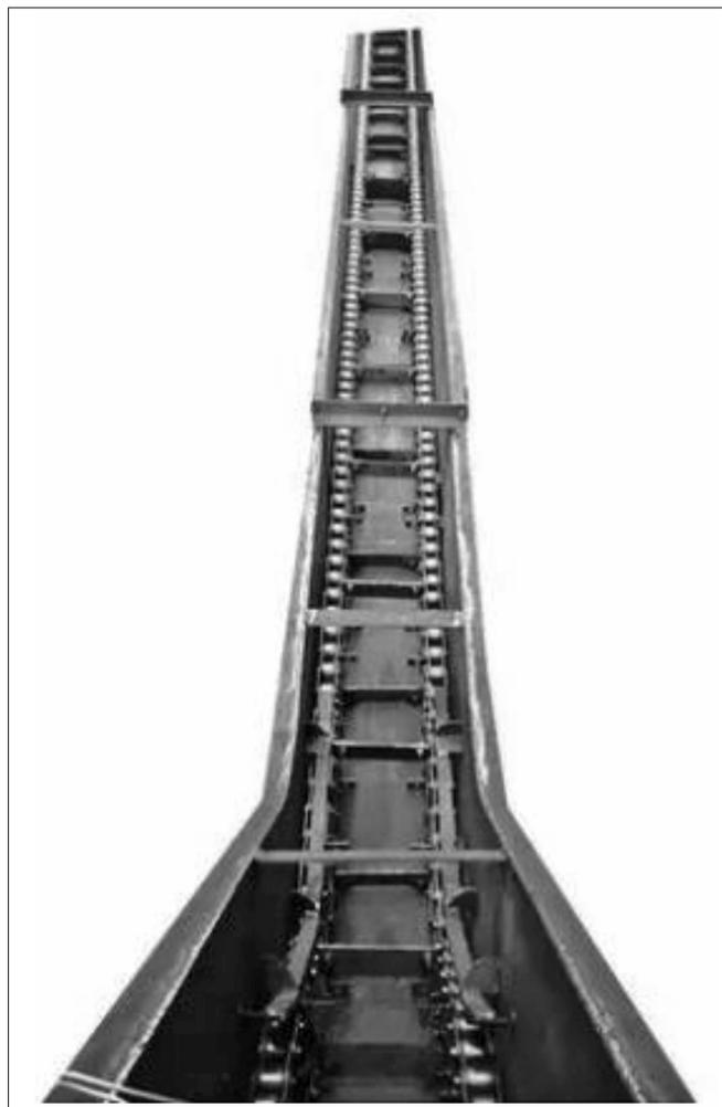
图 双链刮板输送机基本结构示意图
