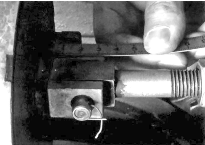
图 3 相关人员测量电磁铁芯与电磁阀的金属圆筒末端距离
