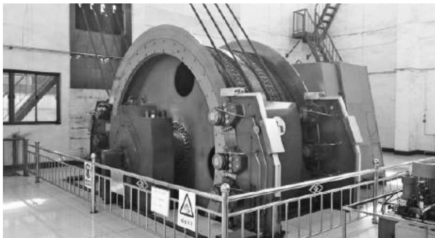
图2 摩擦式矿井提升机
