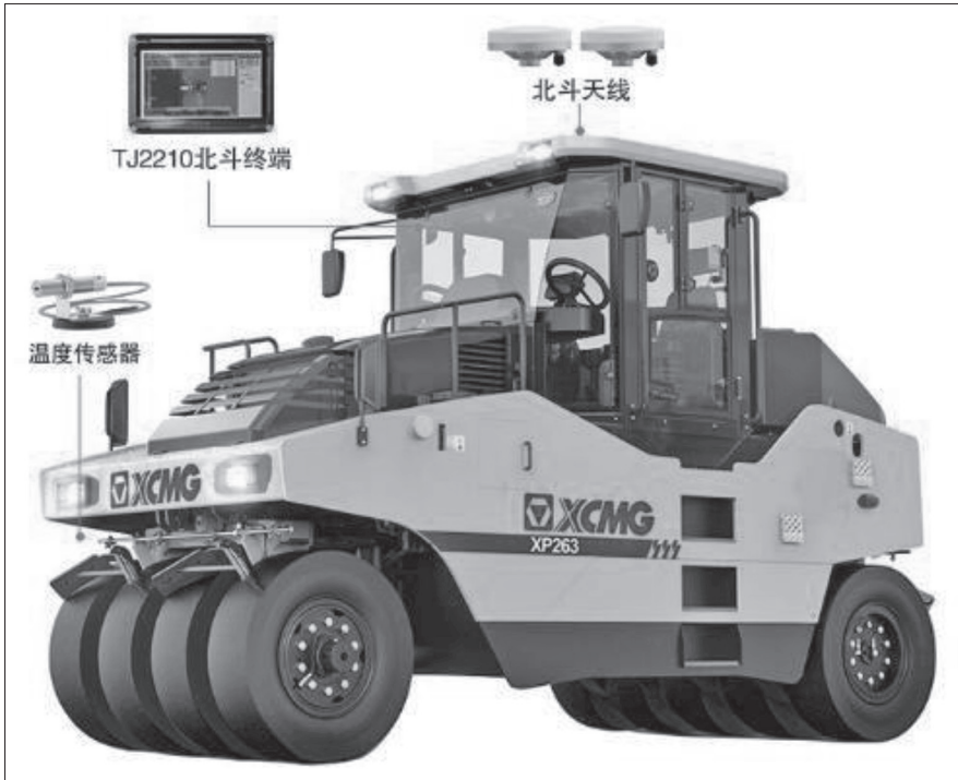
图2 基于信息化管理的施工机械设备配置
