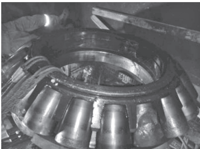
图1 滚道磨损剥落
