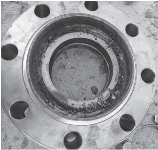
图 机械密封磨损的实物照片
