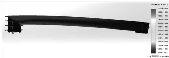
图8 吸盘管道的应力分析
