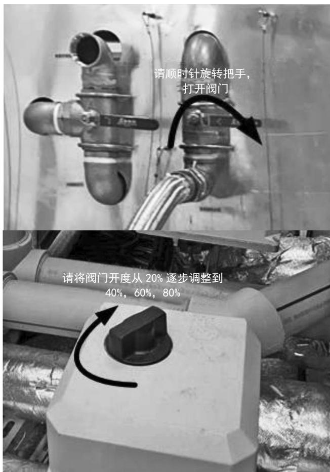
图4 基于混合现实的热工实验指导功能验证
