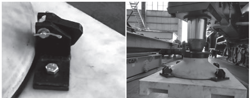
图 6 快速连挂支腿垫块组合连挂状态
