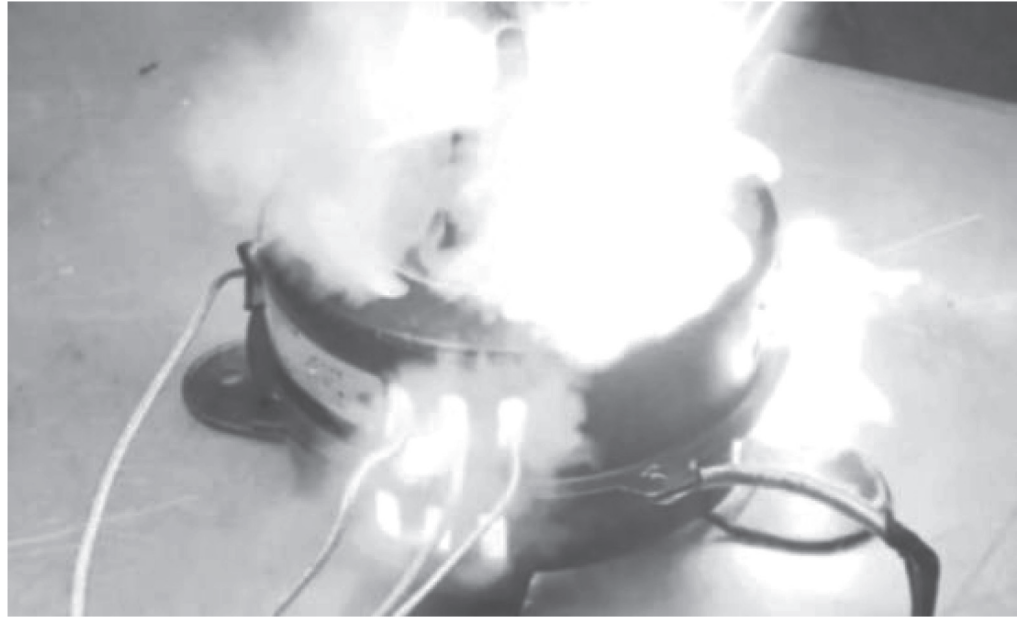
图 电动机模拟试验爆燃
