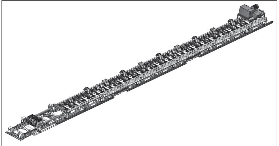
图1 掘进带式输送机用承载自移机尾设计图
