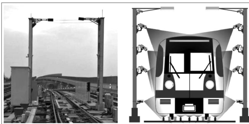
图1 车体360°检测系统应用示意图
