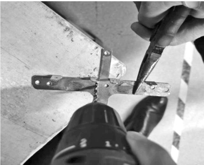
图 2 电磁阀的固定改造
