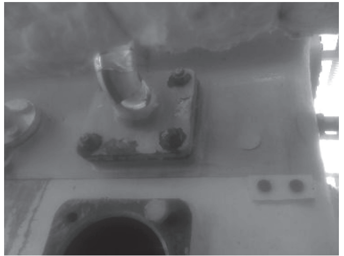
图1 缸体表面油漆过热变色
