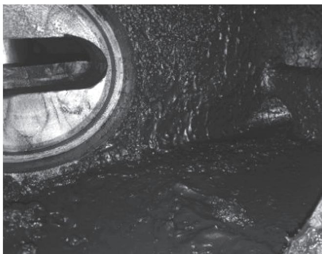
图2 气缸阀腔内部结焦
