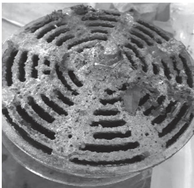
图3 阀罩、阀孔盖表面聚集污垢
