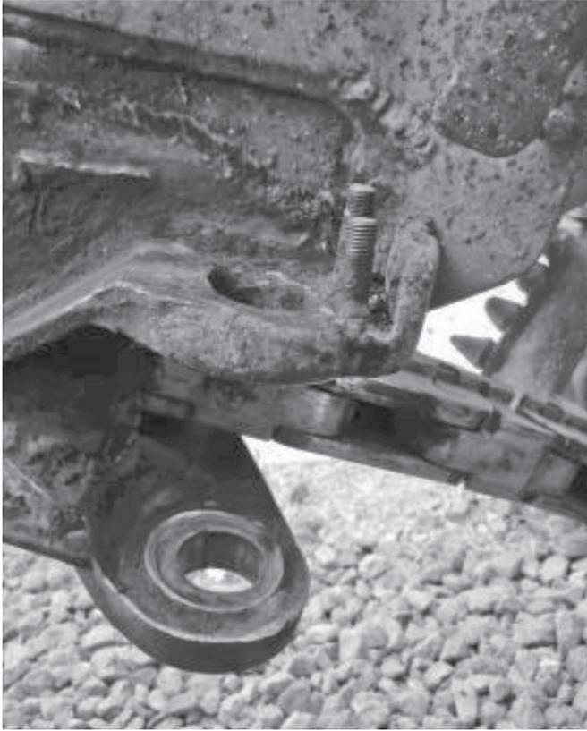
图1 磨损超限的销轴孔
