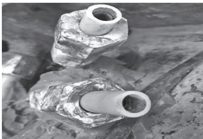
图 5 堵塞的 F46 冷却管路
