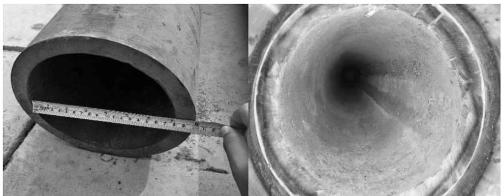
图 8 直管道端照片 (170mm)
