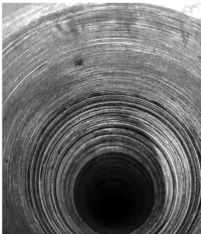
图10 改进前的孔壁粗糙度
