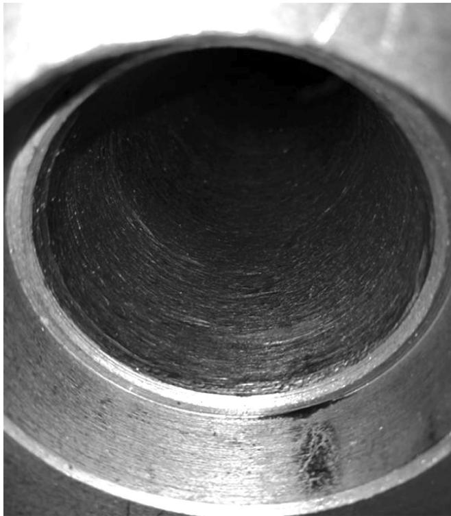
图 11 改进后的孔壁粗糙度
