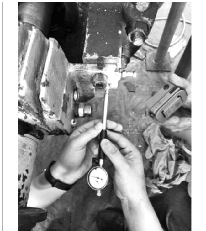
图8 重新铰孔后测量定位孔尺寸
