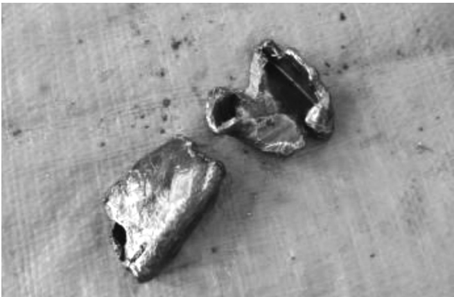
图 5 泵壳体内发现金属碎块
