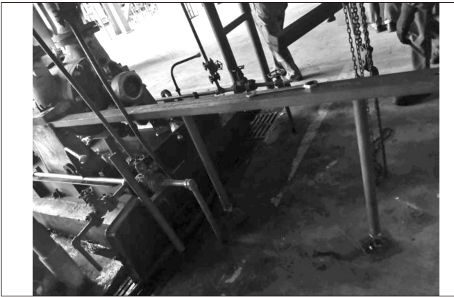
图 2 安装泵整体拆卸安装工具导轨
