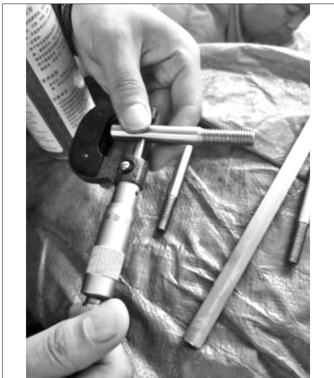
图9 新加工的定位销测量尺寸
