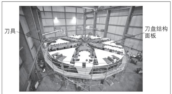
图2 刀盘工厂内整体安装焊接完成实景图
