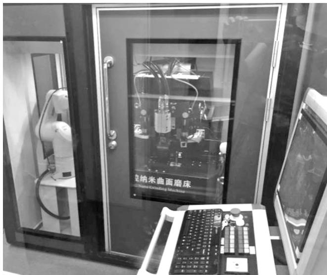
图3 自动化数控纳米曲面磨床系统
