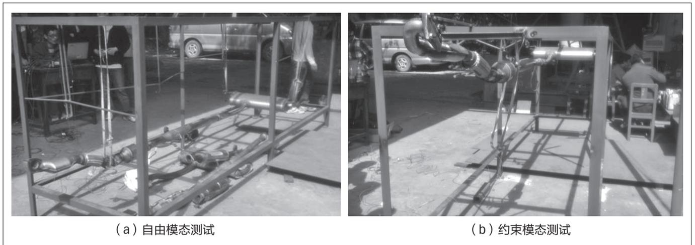
图 2 消声器安装示意图
