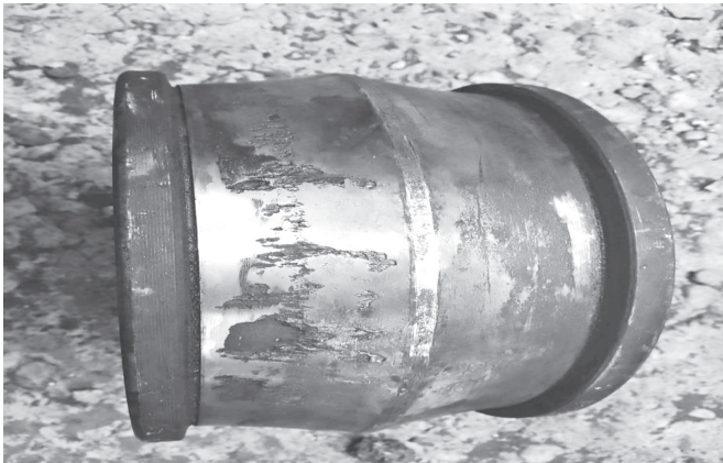
图 6 故障轴承内圈滚道图
