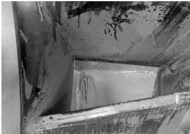
图1 引风机叶轮机翼型叶片端部焊缝开裂情况
