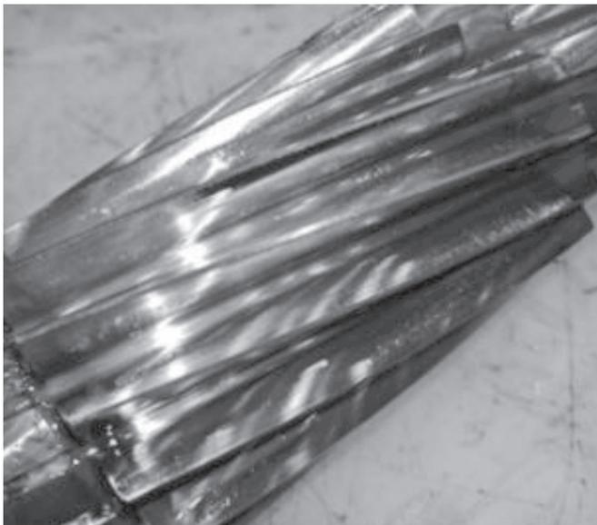
图 7 问题齿轴试验后齿面外观
