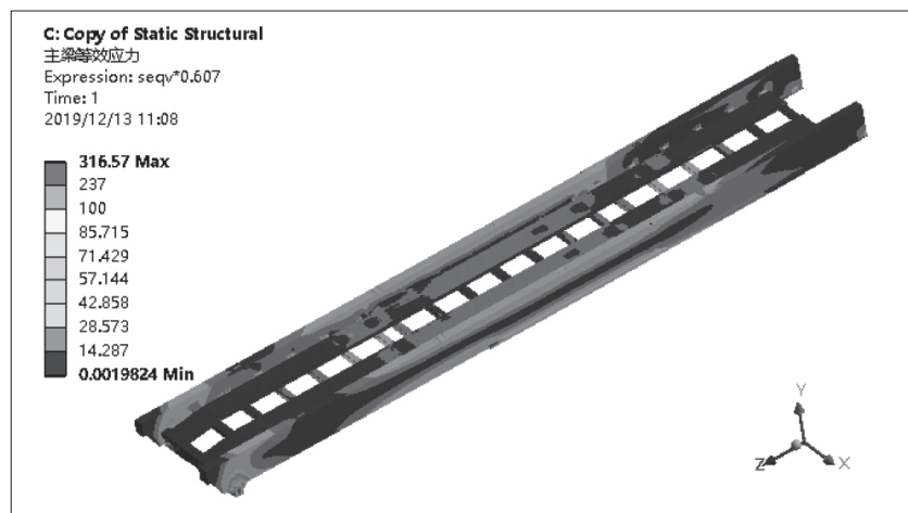
图5 主桥节点应力云图
