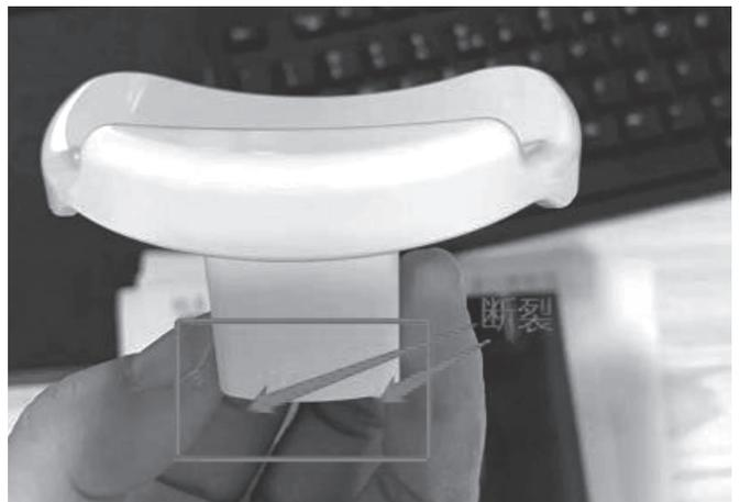
图1 下颌托断裂效果
