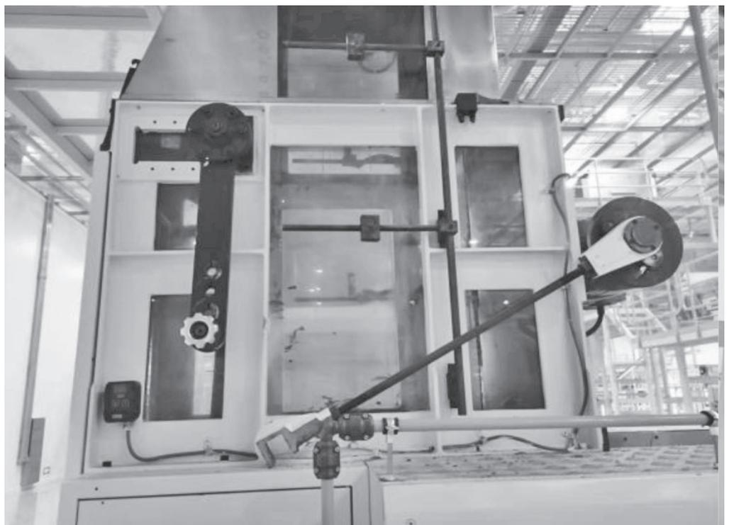
图 4 切丝机推料板变速机构
