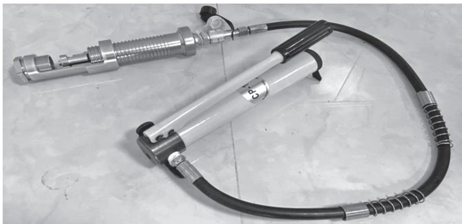
图4 减振器拆装设备实物装配图
