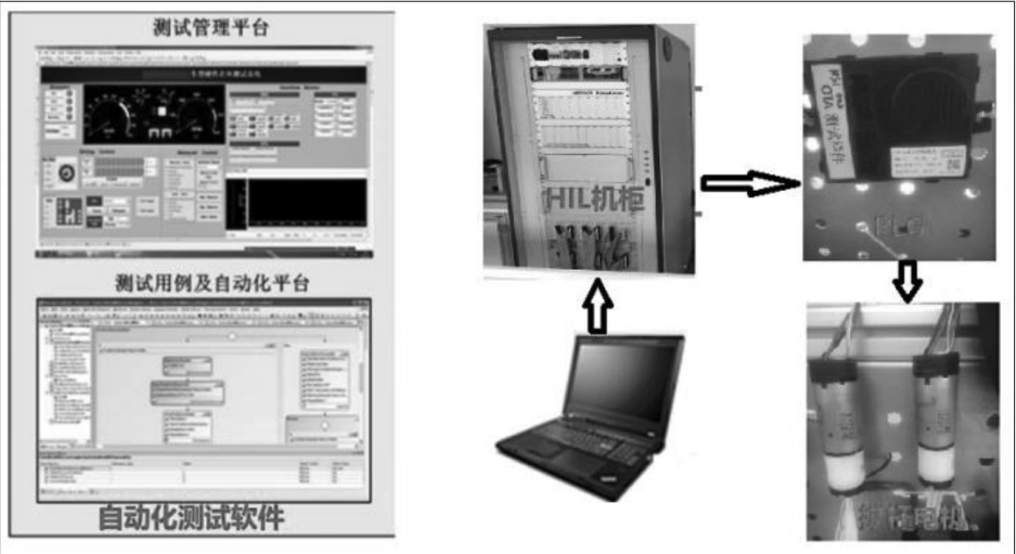
图3 电动尾门 HIL 系统结构
